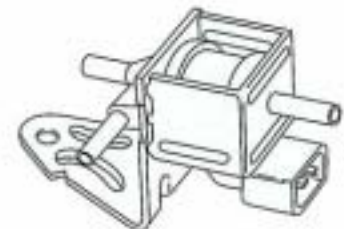
Zweiwegeventil für Kühlmittelabsperrentil
